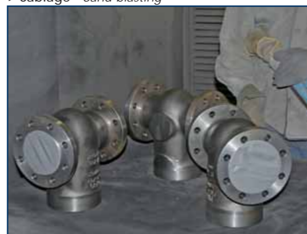
> Sablage - Sand blasting
